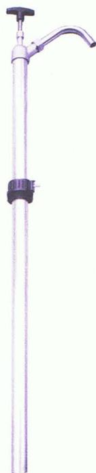
Bei der **Handpumpe JP-17** wurden neben Edelstahl 1.4571 auch der Werkstoff 1.4301 verarbeitet. Die Dichtungen der Pumpe sind aus Teflon, so dass neben der Leitfähigkeit auch eine langfristige chemische Beständigkeit gewährleistet ist. Die Förderleistung beträgt ca. 20 l/ Minute. Die Handpumpe wird daher für nahezu alle dünnflüssigen, neutralen, leicht aggressiven und brennbaren Medien (mit Ausnahme von Aceton) eingesetzt werden können.
